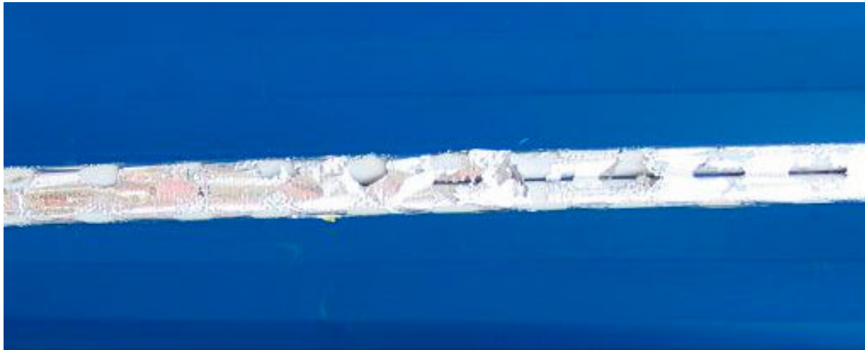
Figuur 6.4: Effect van cavitatie op aluminiumfolie, 10 cm. van sonde
